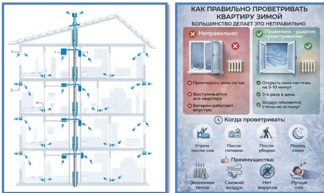
Рисунок 1. Принцип работы вентиляции с естественным побуждением движения воздуха. Проветривание в зимний период.
